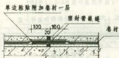
1 密实砂面分格缝构造
