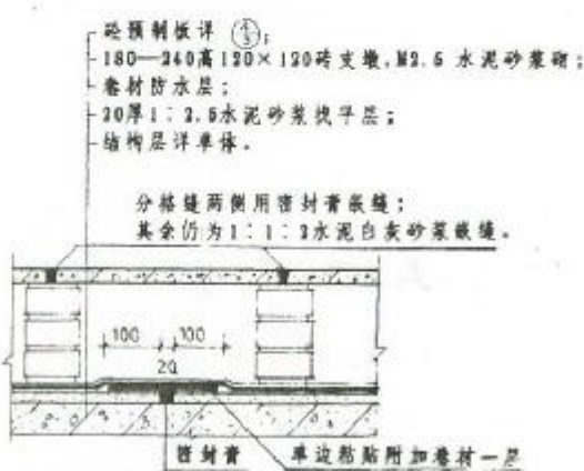
3 架空隔热层屋面分格缝构造
