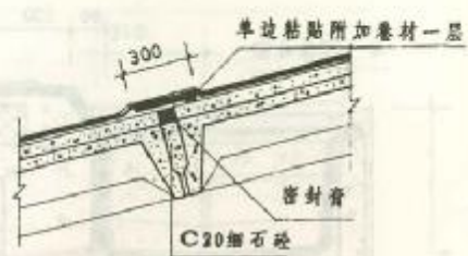
3 板间分格缝构造
