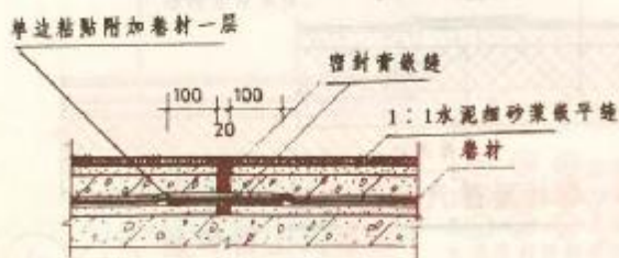
3 地砖面分格缝构造
