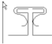
图 1.6.1.2-13 风管铁皮法兰 C 形平插条连接示意图
