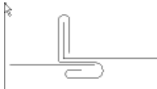
图 1.6.1.2-12 风管立联合角插条连接示意图
