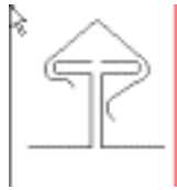
图 1. 6. 1. 2-11 风管铁皮弹簧夹连接示意图
