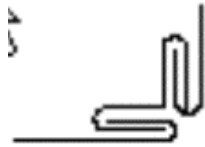
图 1. 6. 1. 2—8 风管直角形插条连接示意图
