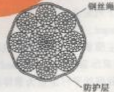
图 3 钢丝绳吊索断面示意
