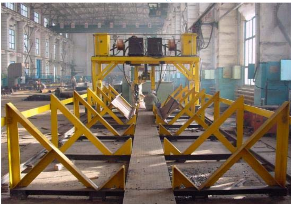
工字钢焊接后使用校型机进行校型处理。
