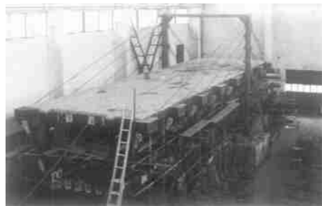
图5 结合板节段模型试验
