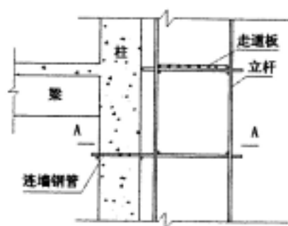
柱连墙件示意
